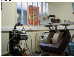
**Types d'échantillons**: tous types sauf matériaux à forte conductivité électrique ou liquides a constante diélectrique élevée (ex. eau),
